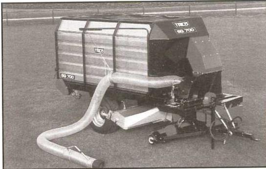
Große Flächen mühelos sauber mit unserem Trilo SG700 Saugwagen. Behälterinhalt 7 m<sup>3</sup>. Arbeitsbreite 2 m - 3 m. Vertikutieren und Absaugen in einem Arbeitsgang.
