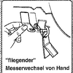
„fliegender“ Messerwechsel von Hand
